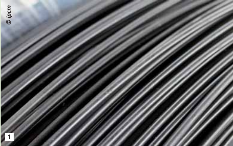
1 A metal wire, the raw material from which springs are created. Il filo metallico: la materia prima da cui sono ricavate le molle.
